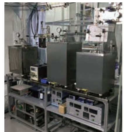
設計・製作した除湿試験機
