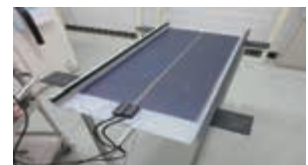
アモルファス型モジュール 融雪温度上昇試験
