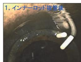
パイル内のシルト止めピンが落下し、有孔部から地下水が孔内に流入
