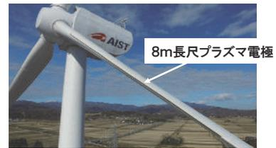
FREA300kW風車（ブレード長16.5m）
