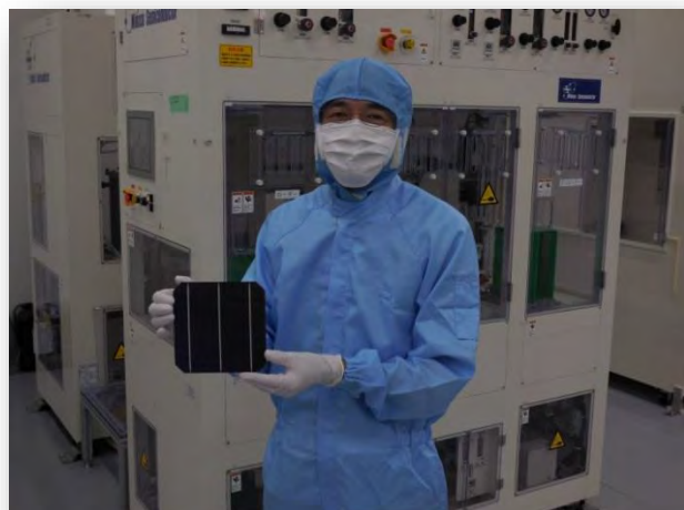
本プロセスで作製された 効率19.3%のセル（厚さは180μm）
