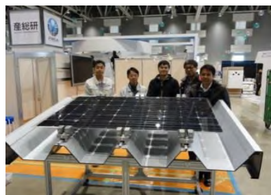
様々なタイプの金具を設計・評価し、当初目標の2400Pa以上の耐荷重を達成。
