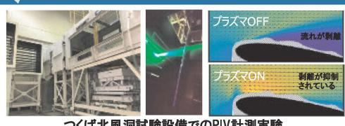
つくば北風洞試験設備でのPIV計測実験
