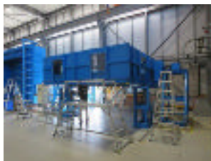
信頼性試験例 （風洞試験（建材試験センター））
