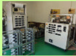
シーズ支援事業等を通じて開発されてきたリナジス社製小型温泉発電装置
