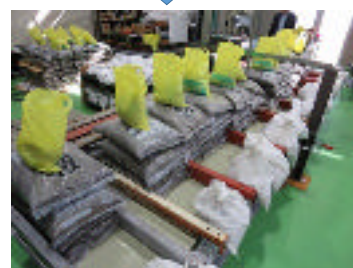
作製した屋根材一体型モジュールの 耐荷重試験の様子 (写真の荷重:5825Pa)
