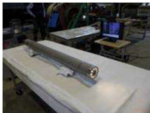
試作したボアホールスキャナー(左:温泉用(～100℃)、右:地熱井用(～200℃))
