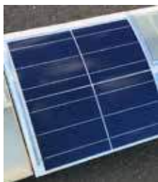
固定翼に搭載した太陽電池モジュールと飛行試験の様子
