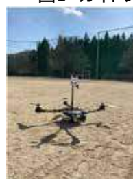
図2 気象観測センサーを搭載したドローン
