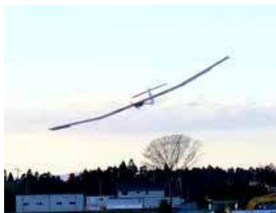
固定翼に搭載した太陽電池モジュールと飛行試験の様子
