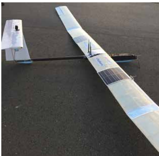
本事業で作製した太陽電池搭載型固定翼ドローン (機体の両翼に4セルモジュールを搭載している)
