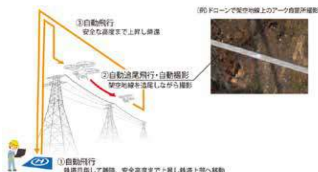
アルプスアルパインが開発した送電設備用自動点検システム
