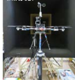
風況計測ドローンの風洞実験
