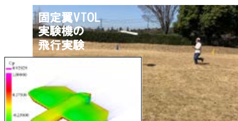
VTOL周りの流れの CFDシミュレーション
