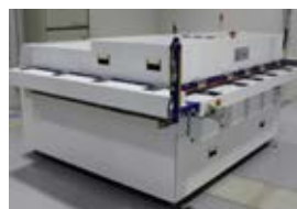
モジュール作製装置(ラミネータ)
