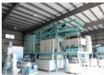
太陽電池モジュールリサイクル装置 (ガラスわけーるⅢ型)
