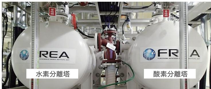
アルカリ水電解装置による水素の製造
