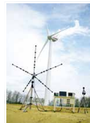
音響センサーによる騒音測定
